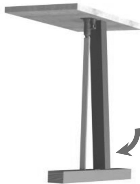
C&D: Fije el bloque localizador al piso con el tipo de tornillo apropiado.
